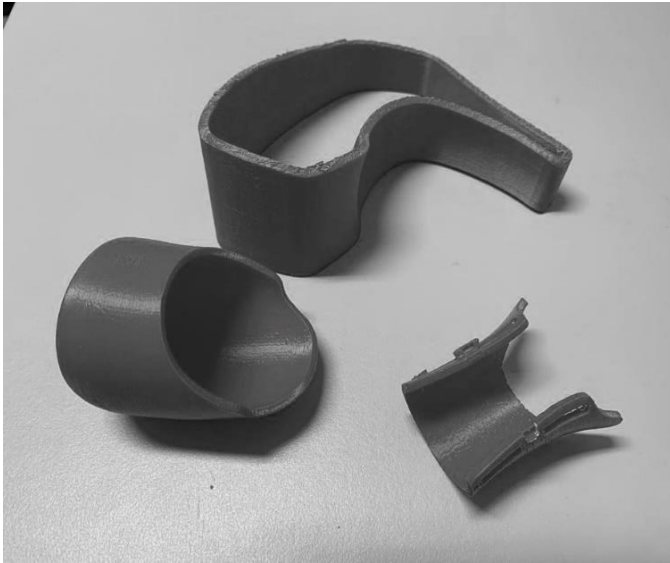
Figura 44 - Peças em PLA - Protótipo P1 (Autor, 2022)
