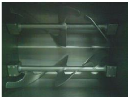
Figura 9: Braços de uma misturadora industrial (Orvalho, 2010)
