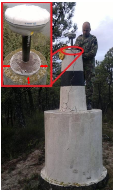
Figura 33 – Pormenor da colocação recetor no VG
