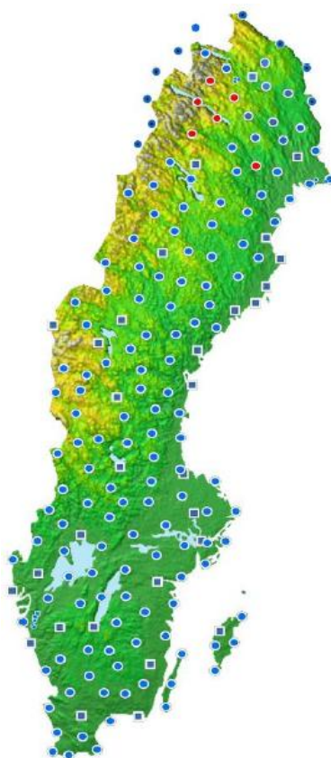
Figura 27 – Rede SWEPOS com as suas cerca de 185 CORS [Jamtnas et al. , 2010]
