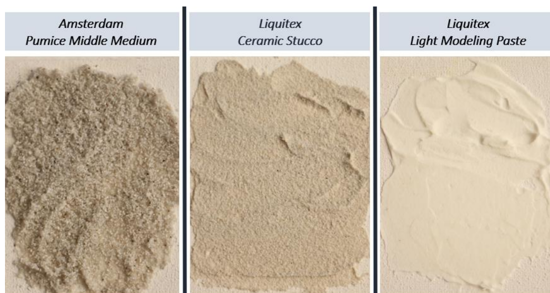
Figura 110. Massas de preenchimento escolhidas para o tratamento de reintegração cromática na fase de testes. Esquema e fotografias por Beatriz Teodoro©.
