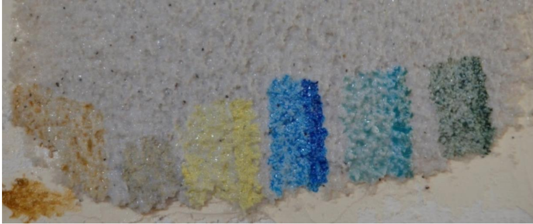
Figura 70. Pormenor de um dos testes de aplicação de cor a húmido nas maquetes realizadas para o estudo das massas de preenchimento. Fotografia de Ana Bailão©.
