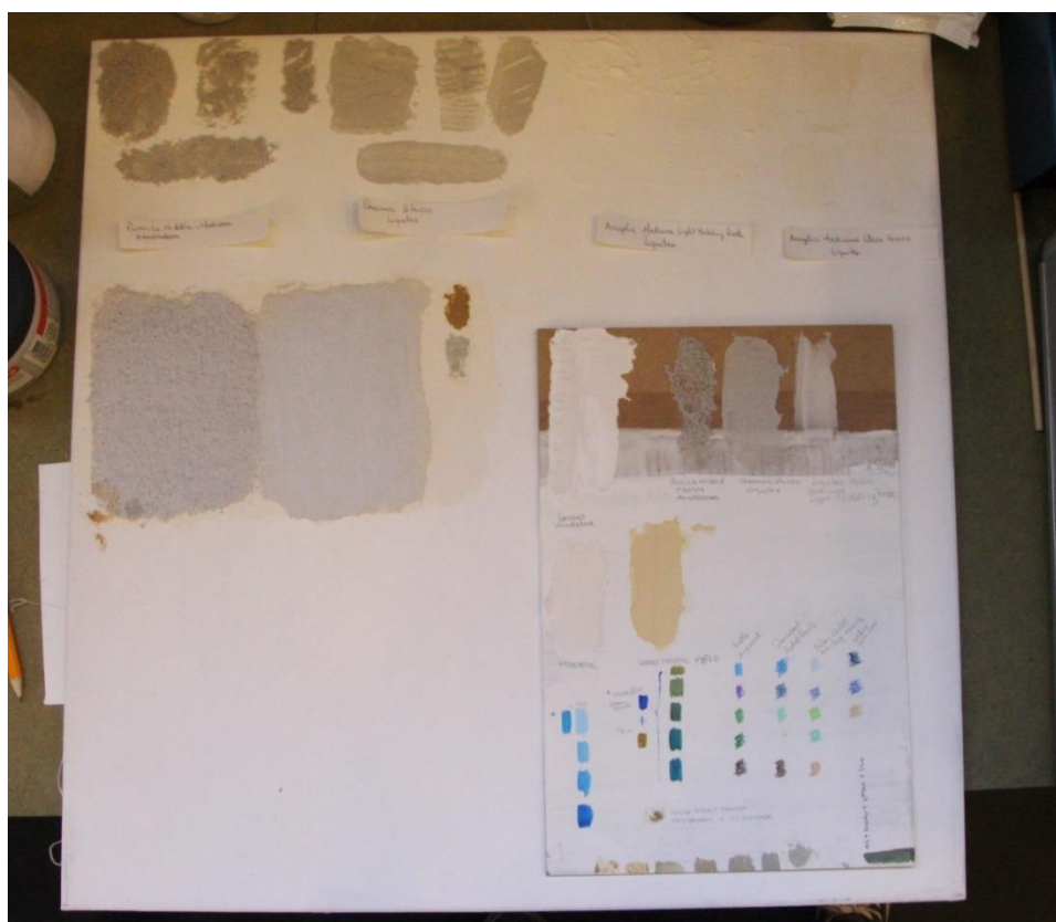
Figura 109. Maquetes produzidas no estudo e teste das massas de preenchimento e pigmentos para o tratamento de reintegração cromática. Fotografia obtida por Beatriz Teodoro©.
