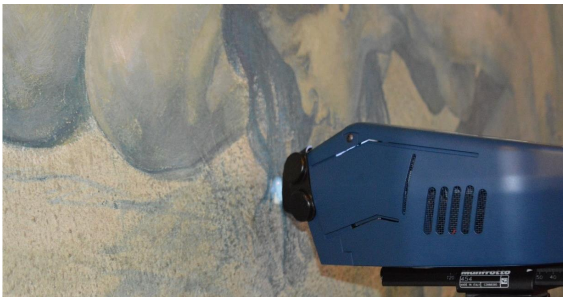
Figura 49. Imagem que representa a técnica de análise Espectrometria de Fluorescência de Raios X, realizada in situ , sobre a pintura 2, correspondente à amostra 003. Fotografia obtida por Frederico Henriques©.
