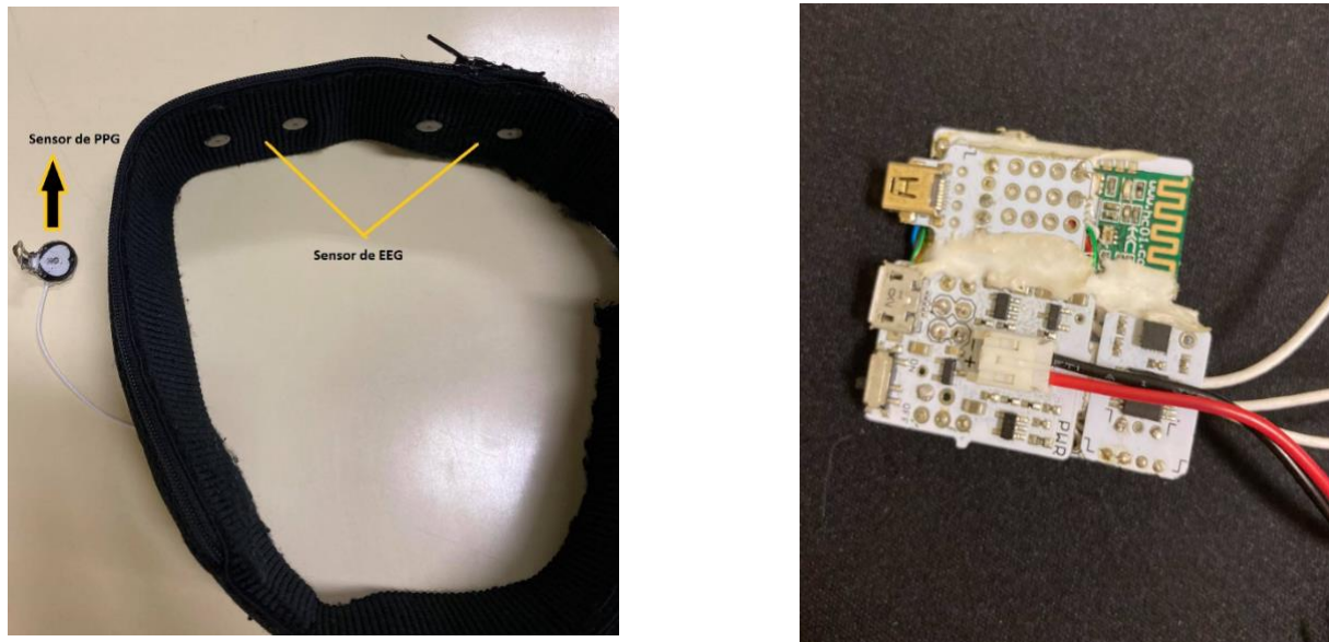
Figura 3.1- À esquerda, a banda BrainBIT. À direita, o bitalino da banda BrainBIT.
