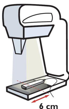
Figura 4.1 - Posicionamento do detetor na medição conforme indicado no manual do fabricante [44].
