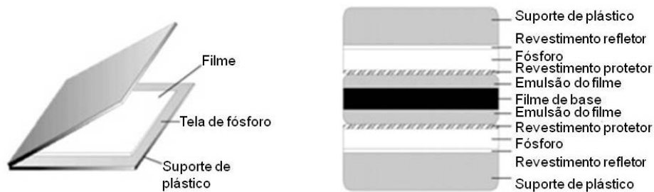
Figura 2.18 – Cassete que mostra a colocação do filme e posição dos ecrãs (esq.). Vista transversal através de um sistema de ecrã duplo usado em radiografia com o filme entre os dois ecrãs (dir.) [17].
