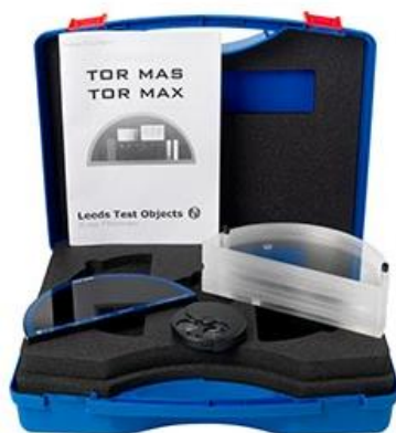
Figura 4.6 – Objeto de teste e placas de PMMA utilizadas no CQ em mamografia [41].
