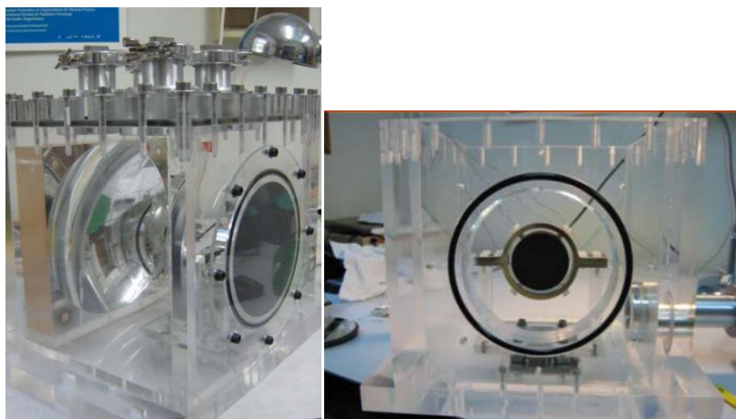
Figura 3.15 – Calorímetro na câmara de vácuo (esq.). Calorímetro visto de frente, sem a janela de grafite (dir.) [39].
