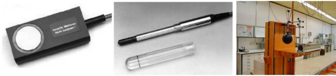
Figura 3.14 - Padrão de dose absorvida na água e kerma no ar para raios X de baixa energia (esq.). Padrão de dose absorvida na água e kerma no ar para ^{60}\text{Co} e raios X de mega voltagem (centro). Um dos padrões, posicionado na mesa experimentalmente na sala de irradiação I (dir.).
