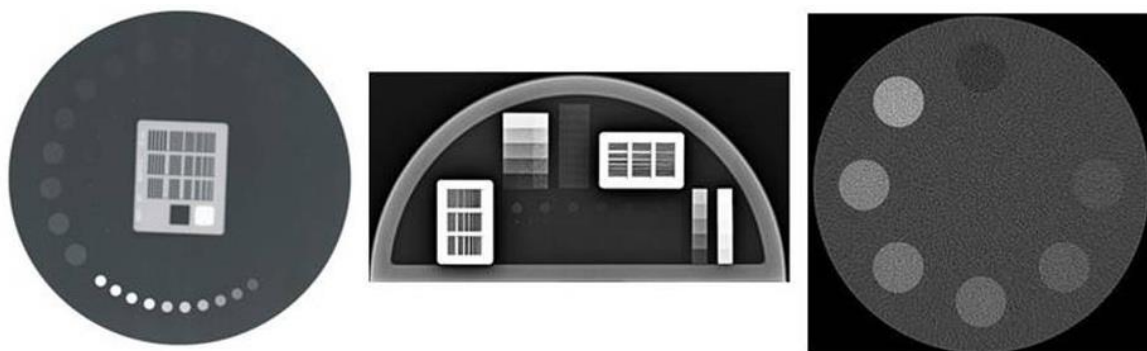
Figura 3.19 - Exemplo de objetos de teste utilizados em Radiografia Convencional (esq.), Mamografia (centro), Tomografia Computorizada para avaliação dos valores dos números CT (dir.) [41].
