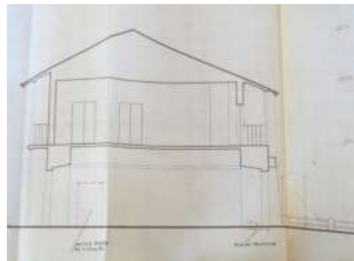
Imagem 91 Corte do edifício principal – elaborado pelo Batalhão de Engenharia de Bissau – com a indicação da porta de ligação entre o corredor e a dependência anexa, bem como da soleira primitiva, 1970. AHU, IPAD, MU, DGOPC, DSUH, 1995, 11314.
