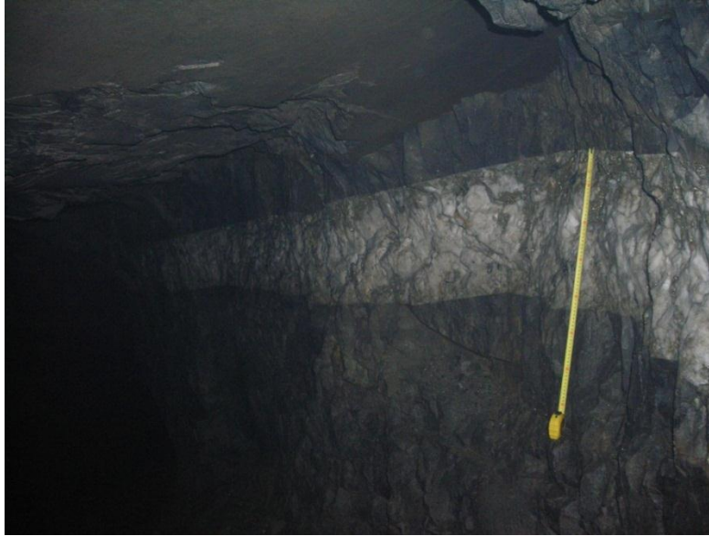
Figura 11 – Filão sub-horizontal do jazigo da Panasqueira. Fornecido pela Beralt Tin & Wolfram S.A.
