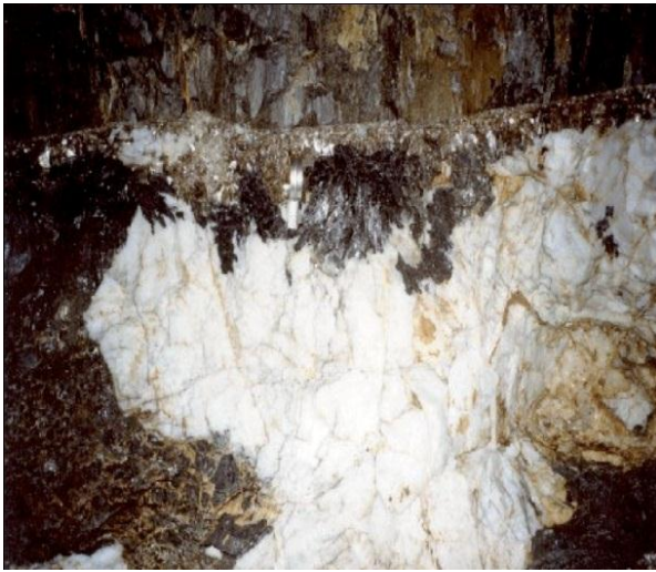
Figura 12 – Salbanda moscovítica e volframite na zona superior de um filão de quartzo leitoso sub-horizontal (Lourenço, 2002).
