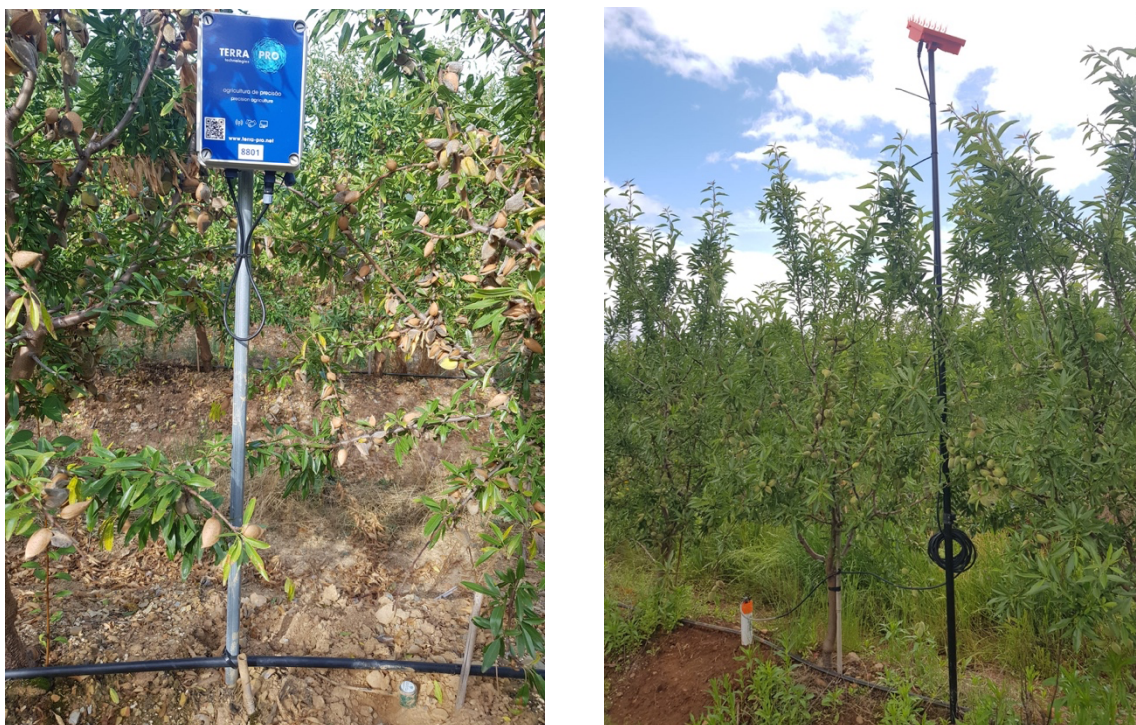
Figura 20 - (A) Sonda de humidade de solo T_{soil} da TERRAPRO ; (B) Sonda de humidade de solo Legacy da AquaSpy
