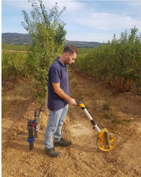
Figura 13 - Medição da área com um odómetro de roda
