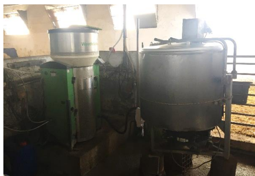
Anexo 5- Maquinaria alusiva ao alimentador automático: dispensário de leite em pó e recipiente automático de leite inteiro.
