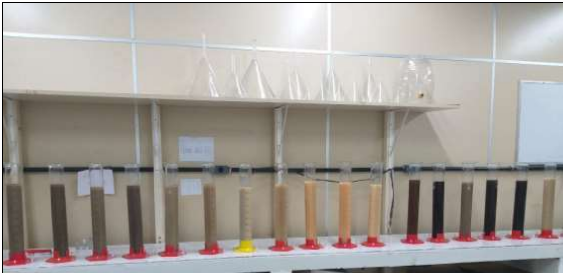
Figura 3.3 – Amostras de solo esperando o tempo necessário para a coleta da argila e silte.
