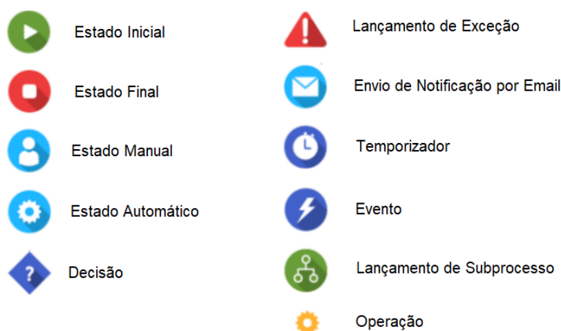
Figura 2.3: Conjunto de elementos da linguagem de modelação de workflows da Framework Omnis
