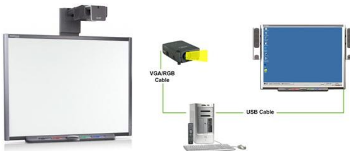
Figura 13. QI SmartBoard e seu funcionamento
