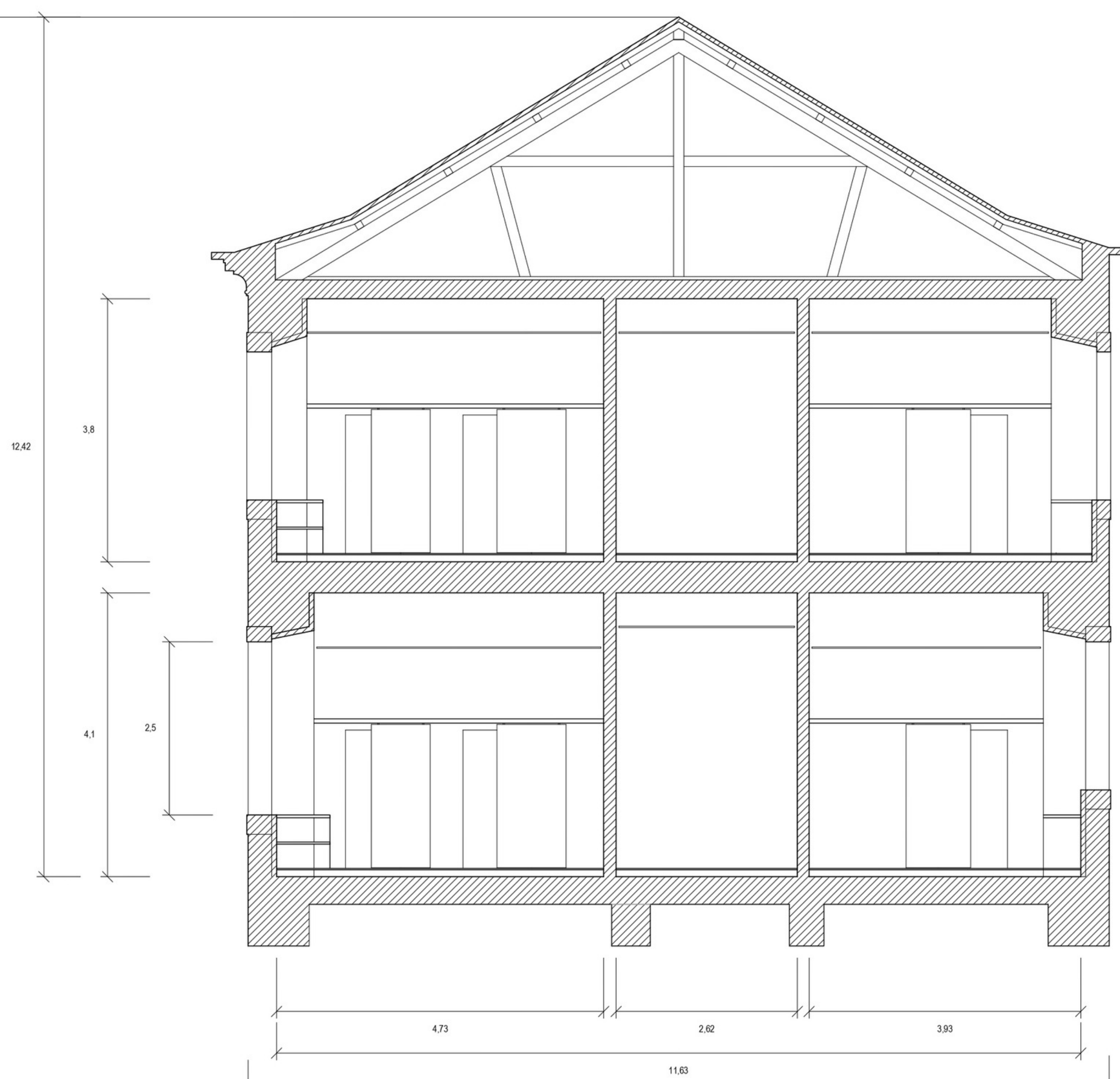
CORTE CÉLULA TIPO A E B ESCALA 1:50
