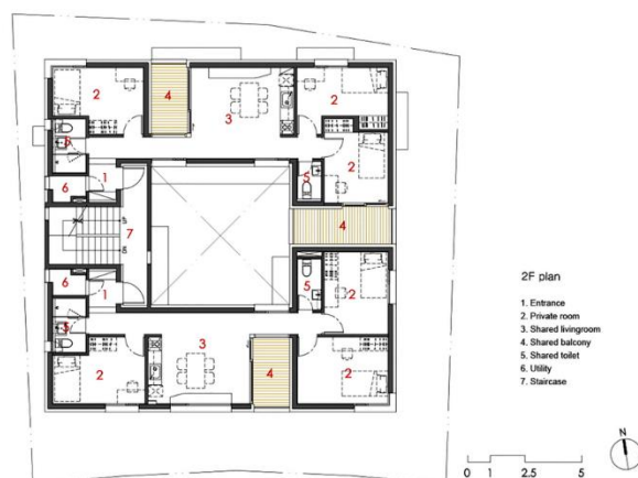
Figura 28 – Planta Piso 2F (Piso tipo)
