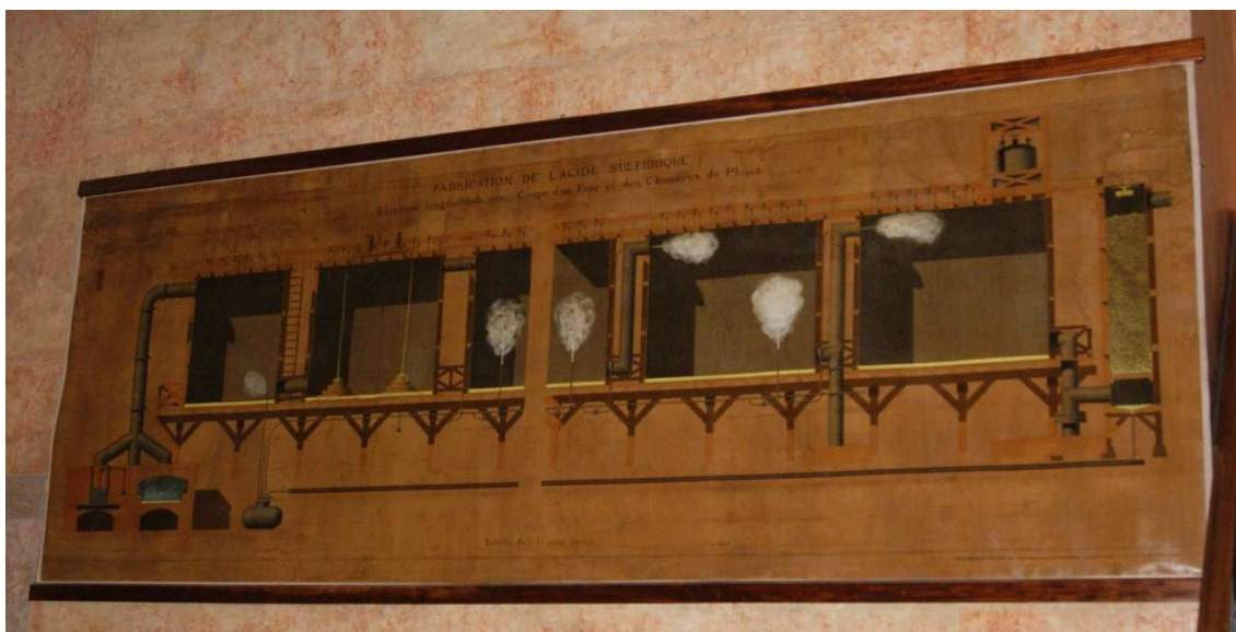
Figura 1: Painel existente no MCUL que mostra um corte vertical numa estrutura física usada para o fabrico industrial do ácido sulfúrico.
