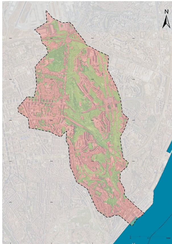
Figura 25 - Grau de impermeabilização da área de estudo (Fonte: Copernicus - Imperviousness Density 2018)
