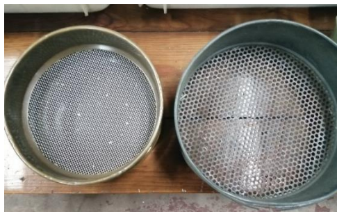
Figura 9 - Crivos utilizados, o da esquerda com uma malha quadrangular de 2 mm e o da direita com uma malha redonda de 4 mm.
