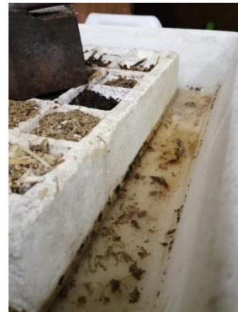
b) Resultado da placa mergulhada em 1 cm de água após 2 dias.
