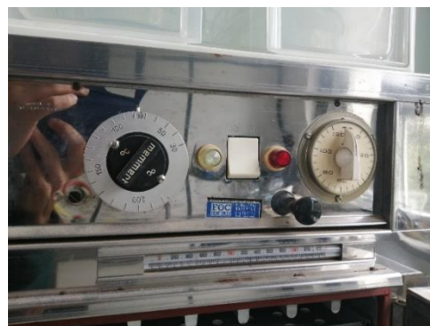
b) Regulação da estufa elétrica (90 °C).
