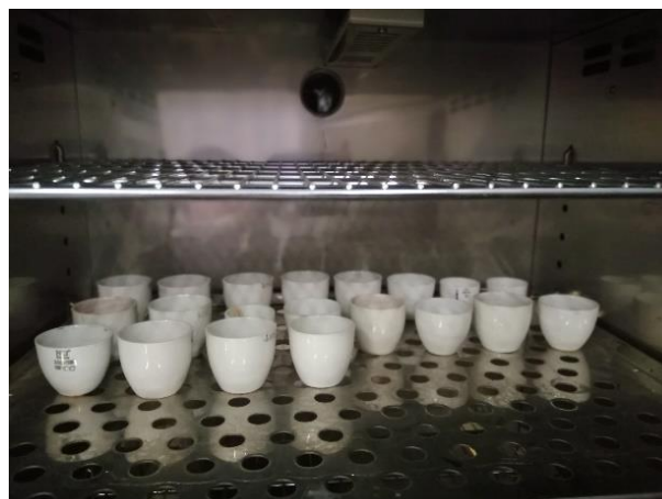
Figura 19 - Demonstração dos copos de porcelana na estufa, que permitiu saber a MS e a humidade.
