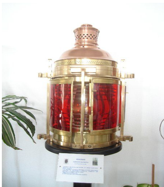
Figura I. 9 Lente com óptica de Fresnel Fonte: Acervo do Museu da D.G.F Foto do autor. Fevereiro de 2007
