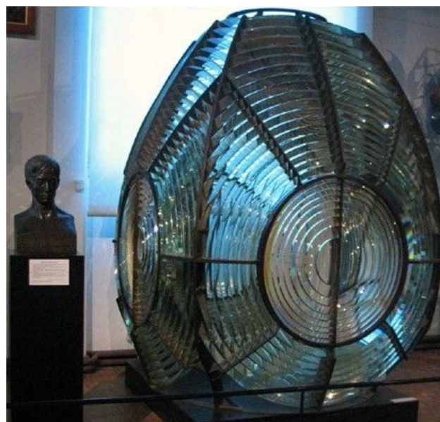
Figura I. 10 Aparelho lenticular de Fresnel Exposta no Musée National de la Marine -Paris. Destaque para o busto em homenagem ao inventor Augustin Fresnel Foto do autor. Novembro 2007
