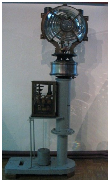
Figura I.5 Representação de um farol que funcionava através de um mecanismo de relojoaria exposto no Musée National de la Marine – Paris Foto do autor, em 10 de Novembro de 2007.
