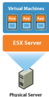
Figura 3.5: Virtualização – Arquitectura física actual
