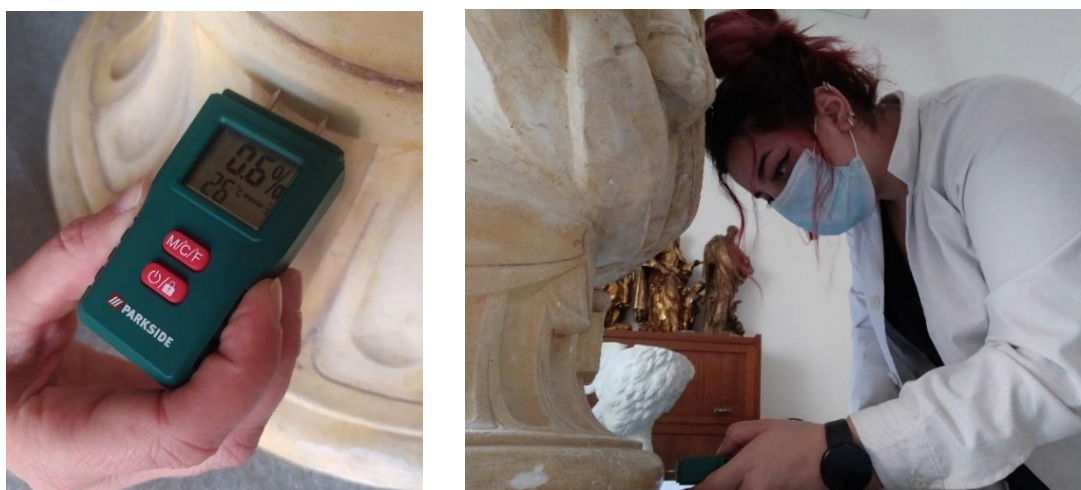
Figura 33 | Esquerda: higrómetro. Direita: processo de medição de humidade. ©Débora Chaves.
