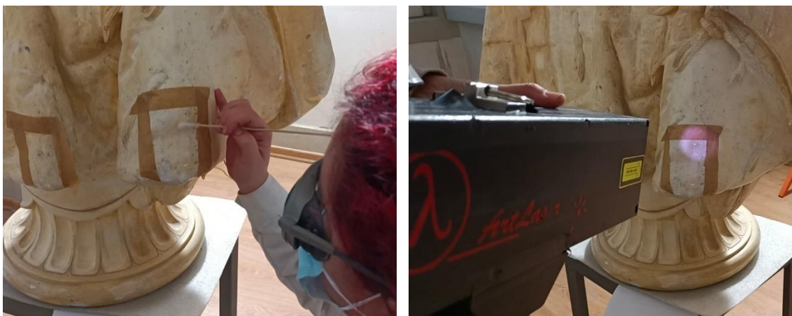
Figura 49 | Esquerda: humedecimento da área; direita: aplicação do laser em zona de teste. © Marta Frade.
