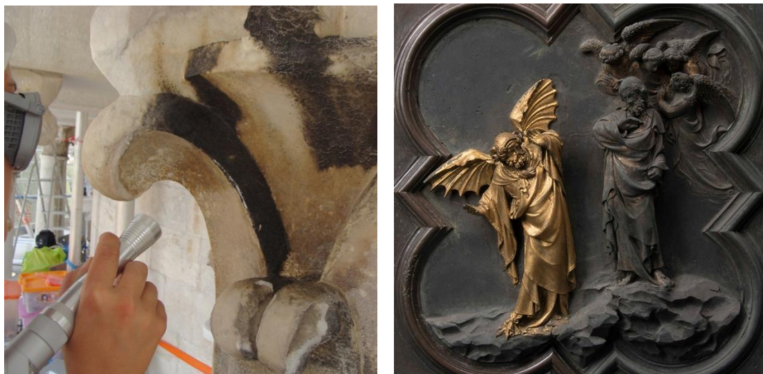
Figura 14 | Esquerda: Utilização da máquina a laser em pedra. Direita: Gates of Paradise de Lorenzo Ghiberti, relevo em bronze com teste de limpeza a laser. © Assorestauro.org /© Opificio delle Pietre Dure, Annalena Brini, Stefania Agnoletti, Nicola Salvioli; lightforart.com.
