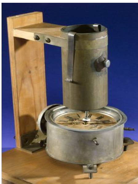
Figura 13. Câmara de difracção de raios-x com relógio de alarme, de Bernal, c. 1940 (imagem retirada do site do Science & Society Picture Library , mais especificamente a partir da página: http://www.ssplprints.com/image.php?imgref=10437802 ).
