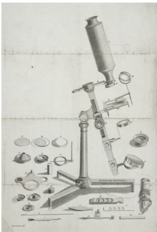
Figura 8. Gravura de um desenho de R. H. Laurie, mostrando um microscópio com etiqueta Dolland, Londres, século XIX, e as suas peças constituintes (imagem retirada do site do Science & Society Picture Library , mais especificamente a partir da página: http://www.ssplprints.com/image.php?imgref=10422190 ).
