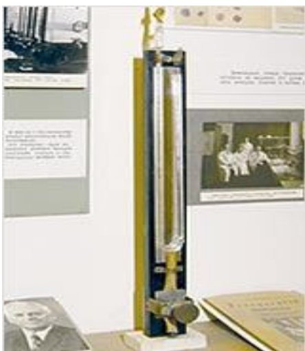
Figura 21. Manómetro de Warburg utilizado por Vladimir Engelhardt na Universidade de Kazan, c. 1929 (imagem retirada do site do Museu de História da Universidade de Kazan, mais especificamente a partir da página: http://www.ksu.ru/miku/eng/ekskurs/fzl/index.php ).
