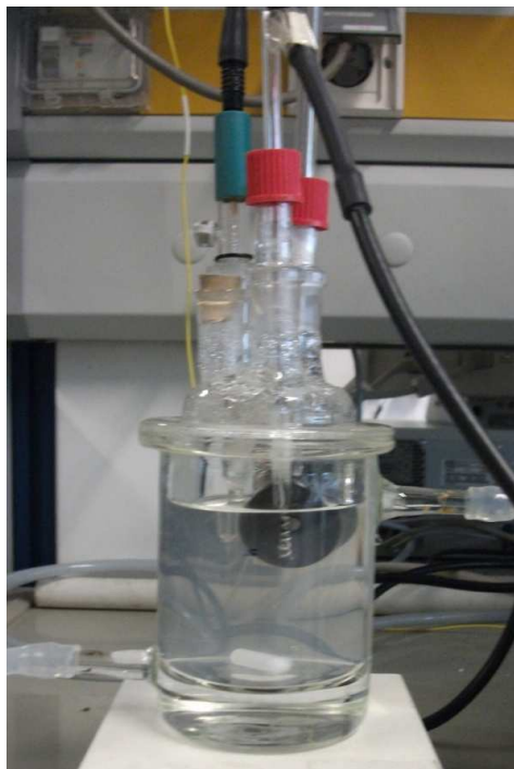
Figura 20 – Célula electroquímica de três eléctrodos
