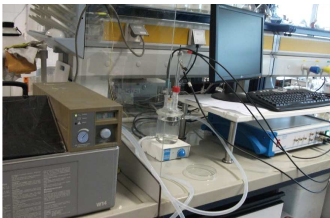
Figura 21 – Célula electroquímica de três eléctrodos e equipamento utilizados para as experiências electroquímicas
