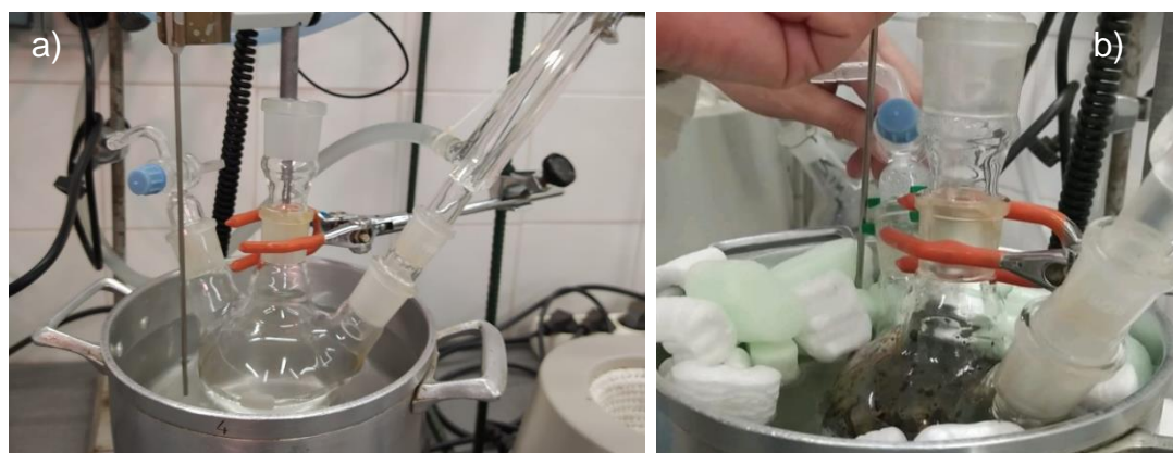
Figura 2 – a) Representação do procedimento de produção das nanopartículas ferromagnéticas antes da admissão dos reagentes. b) Aparecimento de uma cor escura indica que a reação ocorreu.
