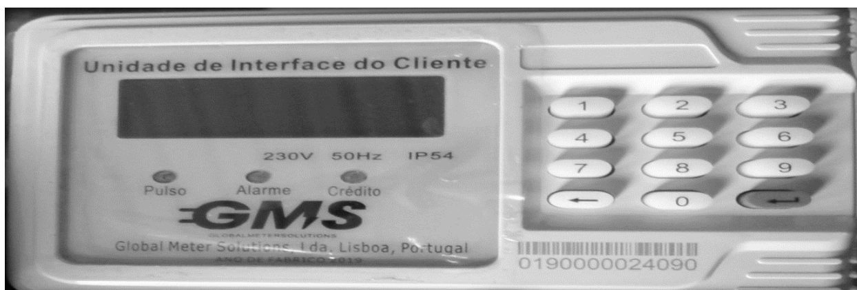
Figura 4.25. Unidade interna do contador elétrico pré-pago: componente digital do setor.
