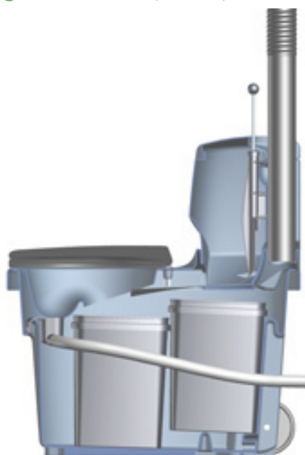
Figura 44 - Funcionamento de um sanitário Biolan
