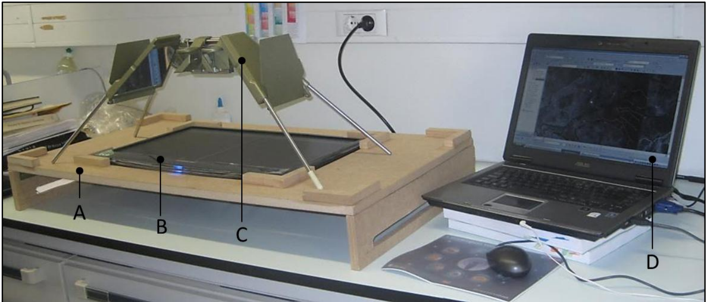
Figura 4.2. Sistema de observação em esteróscopia de fotografia aérea em formato digital para auxílio no desenho cartográfico vectorial. A – Mesa de observação; B – Monitor LDC auxiliar; C – Estereoscópio de mesa; D – Computador.
