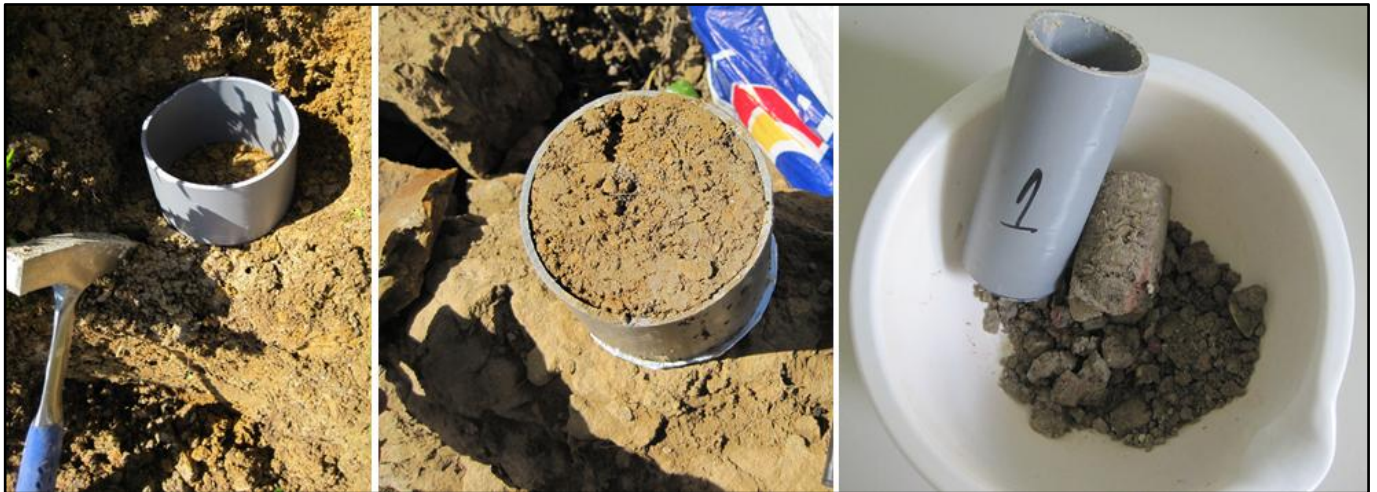
Figura 4.4. Amostradores de PVC para a recolha de amostras de solo.
