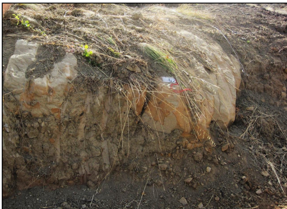
Figura 5.7. Camada de Arenito micáceo do Complexo Camadas de Abadia onde se podem verificar marcas de uma retroescavadora que removeu parte da bancada.
