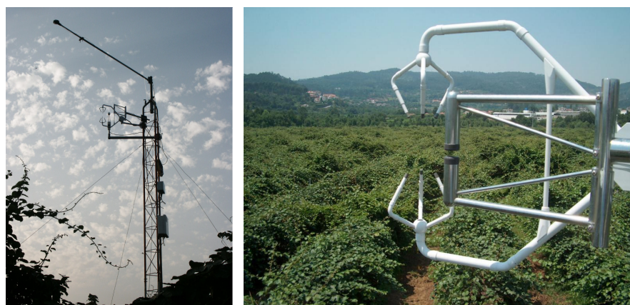
Figura 4.11 – Fotografias da instalação dos sensores do método das flutuações instantâneas na torre de observações micrometeorológicas, no pomar de Briteiros.
