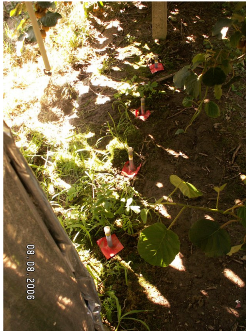
Figura 4.5 – Fotografia da protecção plástica colocada nos tensiómetros para impedir o escoamento preferencial de água ao longo da cana dos sensores.
