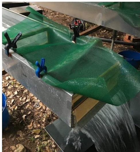
Figura 2.6: Secção de aclimação a jusante do canal (0,6 m de comprimento e 0,4 m de largura) delimitada por duas redes e coberta por uma rede.
