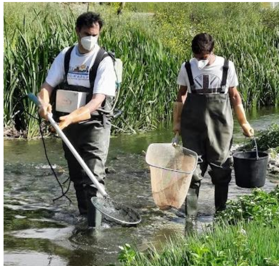
Figura 2.4: Captura dos exemplares de barbo-comum, num troço do rio Lizandro, com recurso a um aparelho de pesca elétrica de corrente contínua (Hans-Grassl IG-200).
