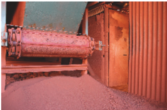
3 - Máquina que mói a argila Fonte: Fotografia de Felipe da Palma
