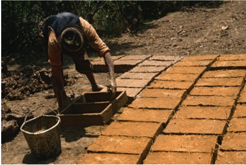
Figura 8 - Tijolos de adobe moldado, fabricado manual com pouco equipamento
