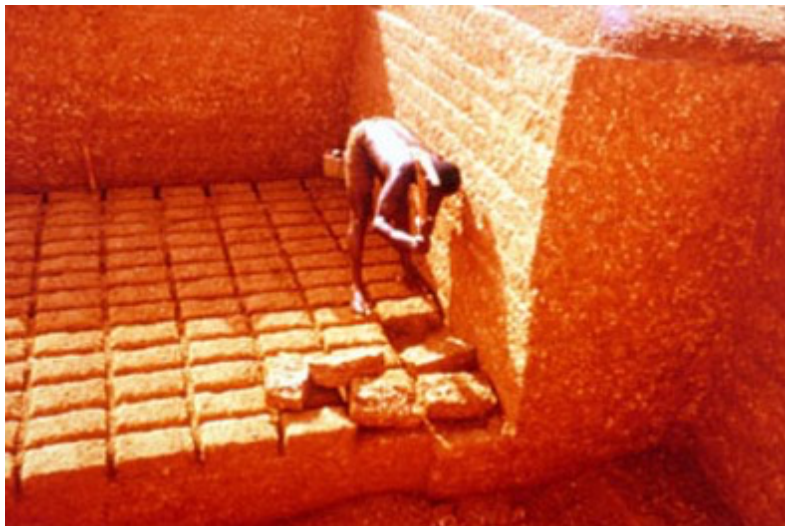
Figura 9 - Recolha de blocos de terra cortada, extraídos em locais específicos (Kari)
