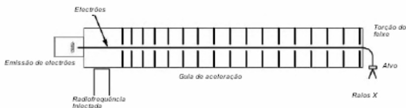
Figura 7 - Pormenor de tubo de aceleração de um acelerador linear (Mayles, 2007).
