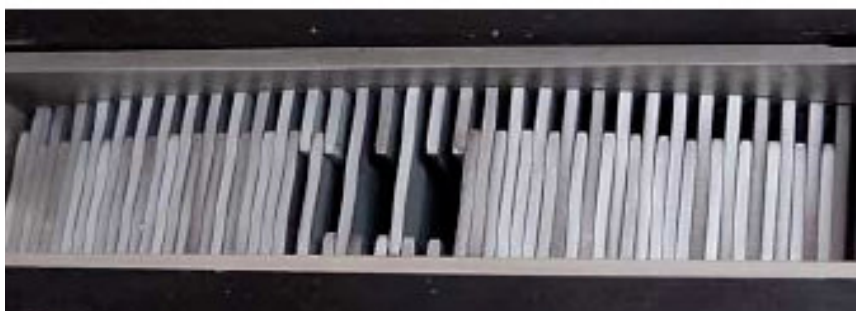
Figura 21 - Pormenor de Colimador Multilâminas de uma tomoterapia (Van Dyk et al, 2007).
