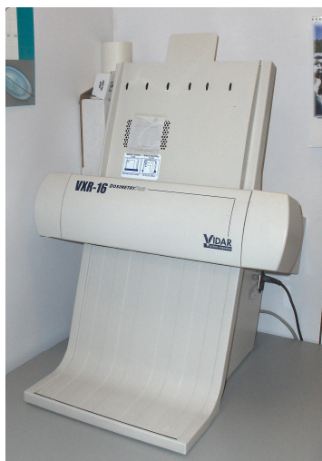
Figura 31 - Scanner Vidar utilizado para a digitalização de todas as películas.
