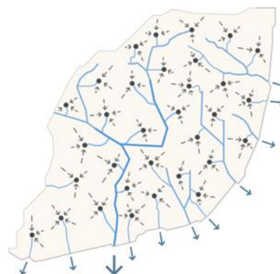
Figura 45- Sistema de drenagem proposto Autoria: Turma 5ªE
