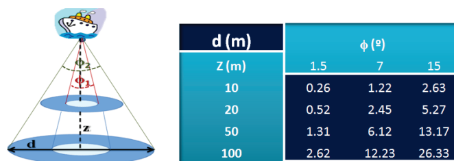
Figura 2.1 - Área insonificada por um feixe vertical cónico
