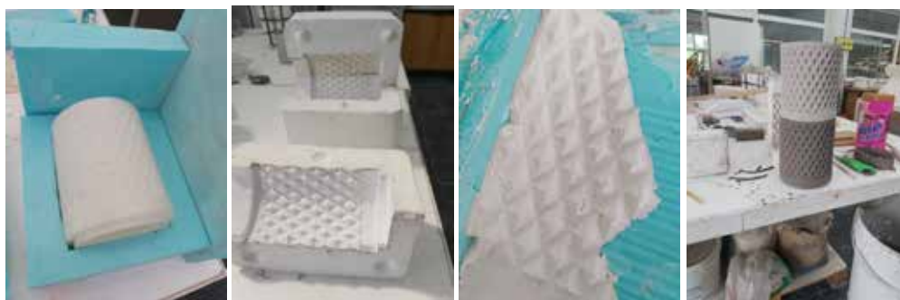
Figura. 33- Molde de gesso a ser feito e as duas primeiras tiragens. Elaborado pela autora, 2023
