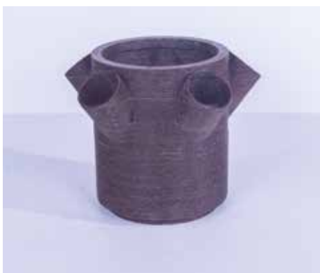
Figura. 28- Módulo impresso em Filamento de cortiça. Elaborado pela autora, 2022
