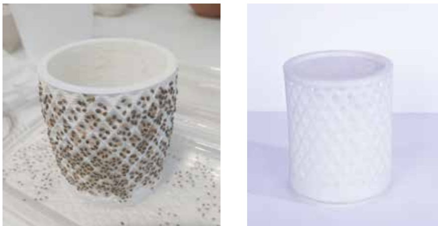
Figura. 32- Módulo com padrão impresso em Pla à esquerda e módulo impresso em Tpu para molde. Elaborado pela autora, 2023
