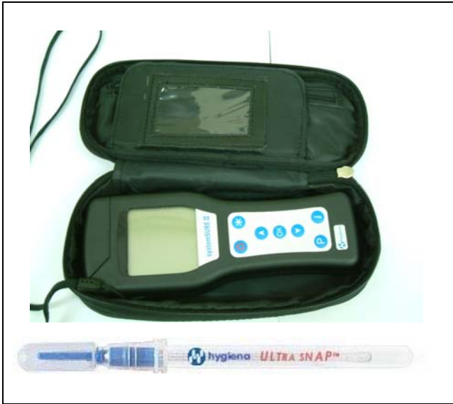
Figura 7 – Luminómetro utilizado para a medição de ATP por bioluminescência e respectiva zaragatoa descartável Ultrasnap.
