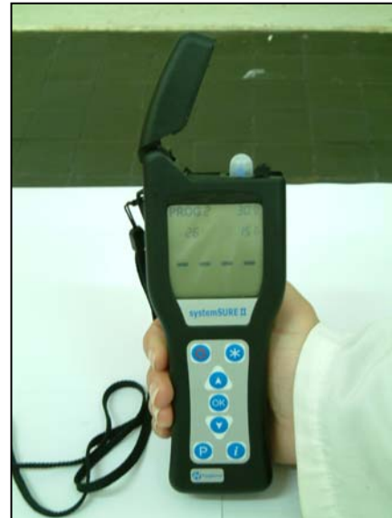
Figura 8 – Luminómetro utilizado para a medição de ATP por bioluminescência, preparado para efectuar medição.
