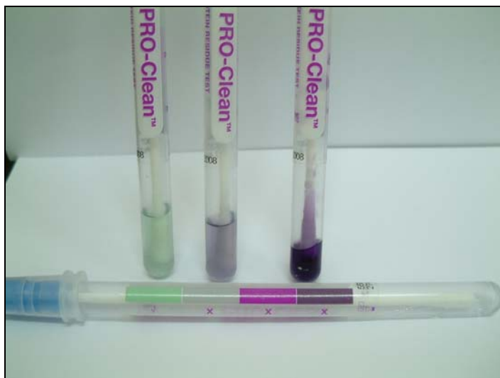
Figura 10 – Zaragatoas PRO-Clean, após colheita das amostras de superfícies com diferentes quantidades de proteína.
