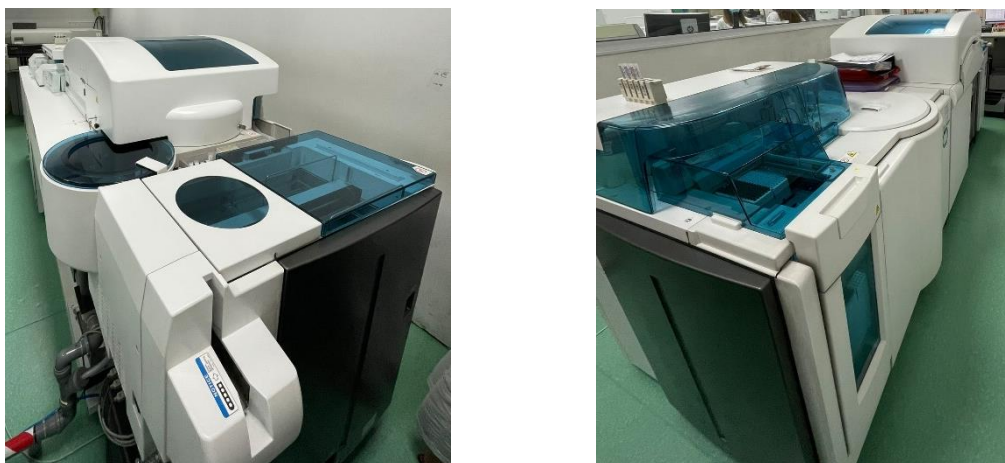
Figura 2 - Equipamento Cobas® 6000 Modular Analyzer Series, da Roche Diagnostics.
