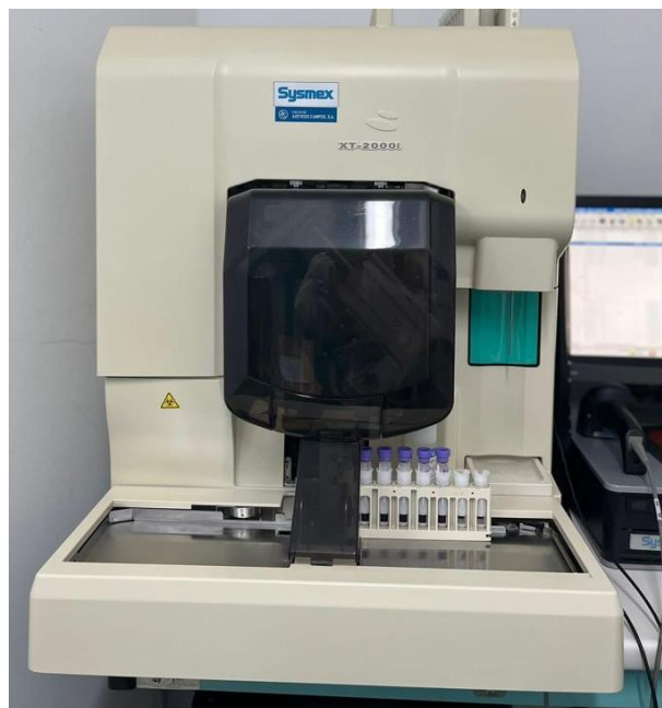
Figura 13 - Analisador Hematológico Sysmex XT-2000i TM .
