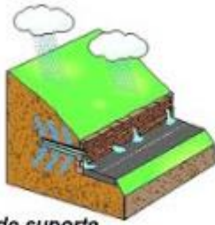
Muros de suporte Canais de drenagem
