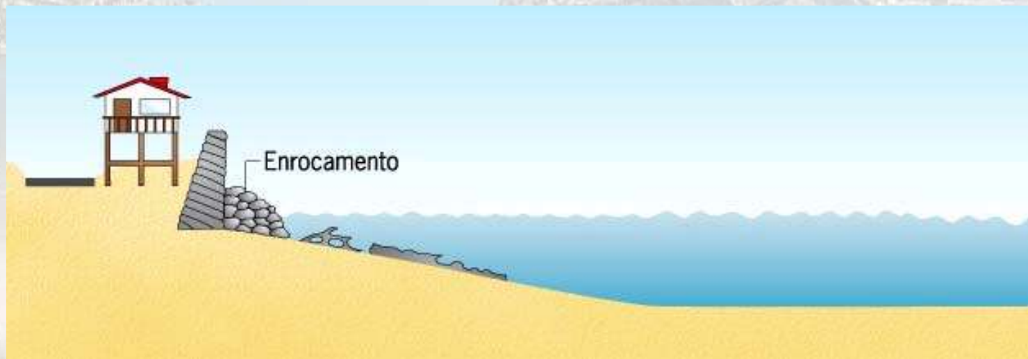
Paredão e Enrocamento
