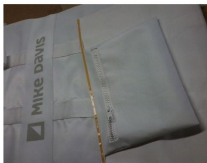
Fig. 82 e 83 - Montagem de saco, pequeno bolso de vinil e aplicação de fecho injetado.
