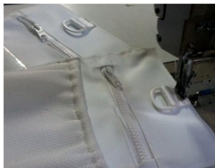
Fig.84 e 85 - Montagem de bolsa interior e aplicação de pressinta.
