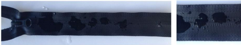
Fig. 98 - Imagem de fechos utilizados para o anorak Mike Davis , com base na imagem da YKK. Teste de repelência à água.
