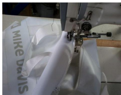
Fig. 82 e 83 - Montagem de saco, pequeno bolso de vinil e aplicação de fecho injetado.
