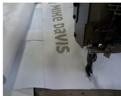
Fig. 81 - Montagem de saco, estudo de estampado e costura de componente estampada.
