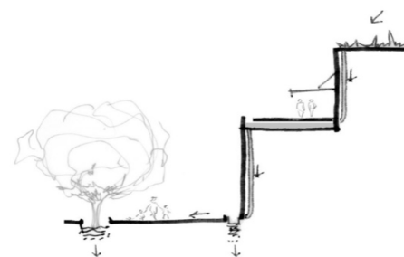
Figura 15 - Esquema “Blue Roofs” Fonte: Maria Matos Silva, 2016, p. 222.
