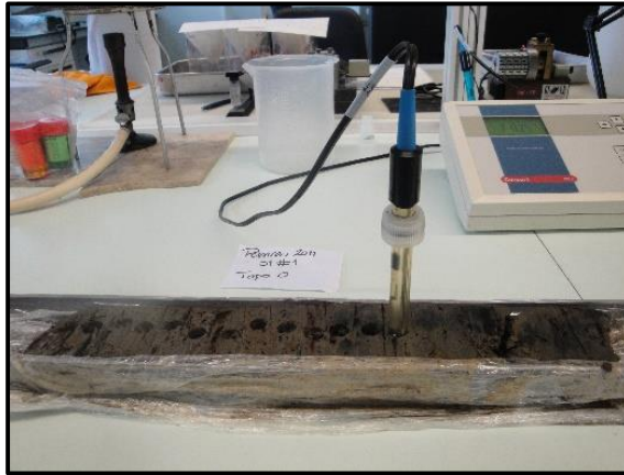
Figura 36 - Medição de pH diretamente na amostra com aparelho de leitura multiparamétrica.
