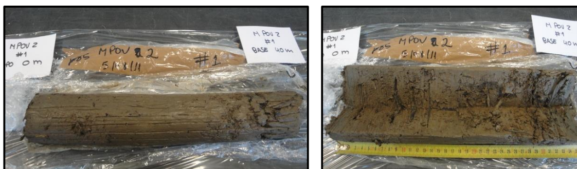
Figura 35 - Abertura de testemunhos de sondagem em laboratório.
