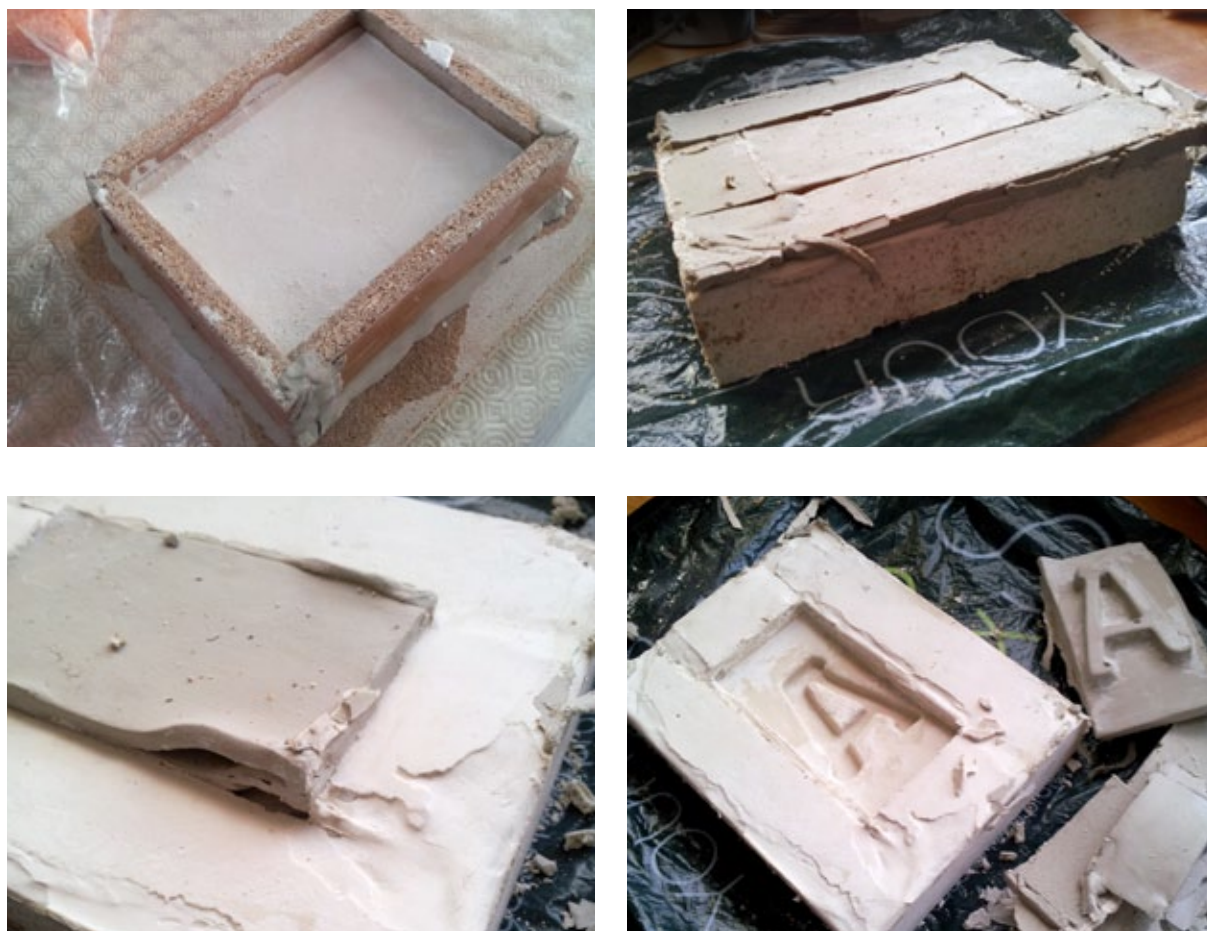
Fig. 158 Processo de produção do molde em gesso (Félix 2013)
