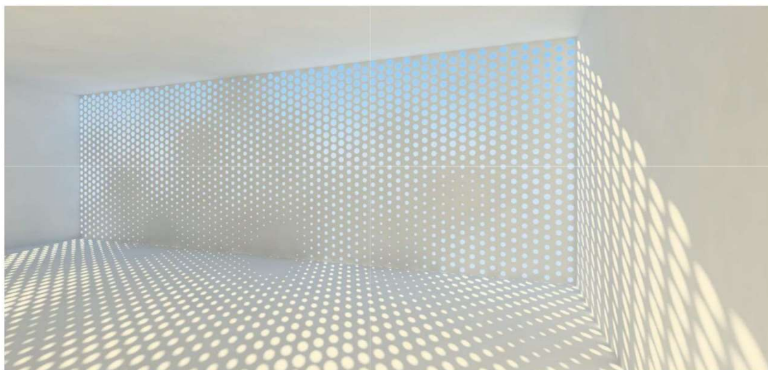
Figura 2.6: Solução de projeto obtida pela ferramenta Opossum para uma parede, a qual proporciona 84% de Iluminação de Luz do Dia Útil, em um contexto com 24% de Probabilidade de Claridade Diurna. Para espaços de escritórios em climas tropicais, este género de paredes, com este tipo de aberturas, podem proporcionar uma economia de energia substancial (no arrefecimento e na iluminação artificial), ao mesmo tempo que evitam a necessidade de venezianas e de outros elementos móveis. (Wortmann 2018, 169)
