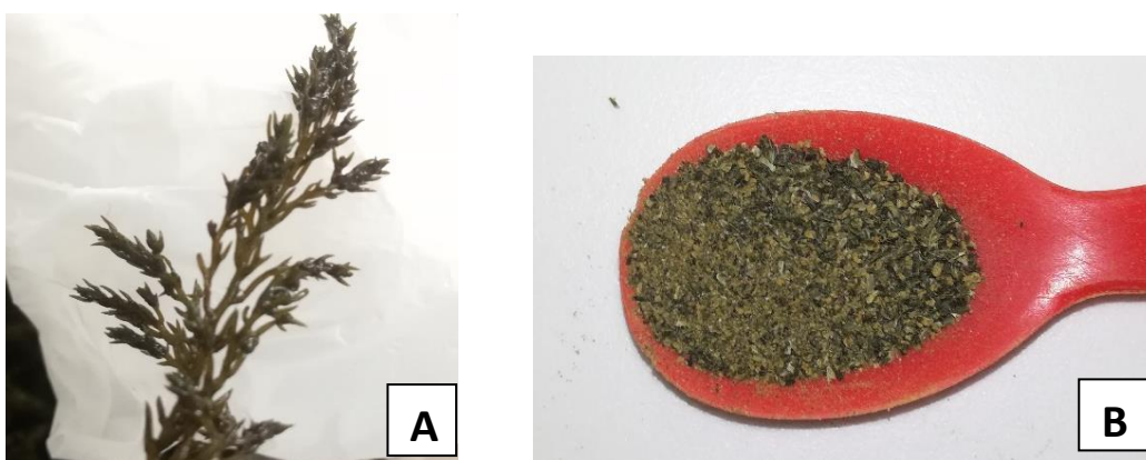
Figura 4- (A)-Amostra de biomassa de E.selaginoides após recolha e lavagem com água doce. (B)- Amostra de macroalga E.selaginoides após moagem no moinho de facas Grindomix GM 200 (Retsch, Alemanha) Jéssica Abreu, 2021
