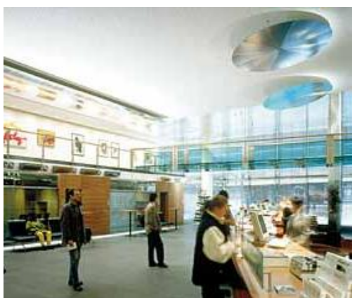
Fig. 57 Salão de Atendimento Geral com Luminárias de Vapor Metálico e Sistema de Rebatimento, Banco Raiffeisen Landesbank – Innsbruck – Áustria
