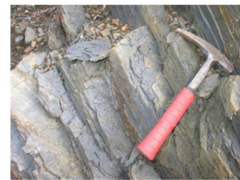
Foto 2. Xisto intensamente mosqueado com alteração de óxidos de ferro na frente 3
