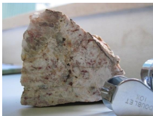
Fig. 4.39 Amostra MR-FQ do filão quartzo da sanja aberta, depois do corte em serra
