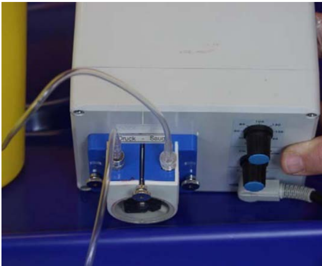
Figura 3 – Dispositivo de perfusão elétrica para simular uma “circulação sanguínea artificial” [12].
