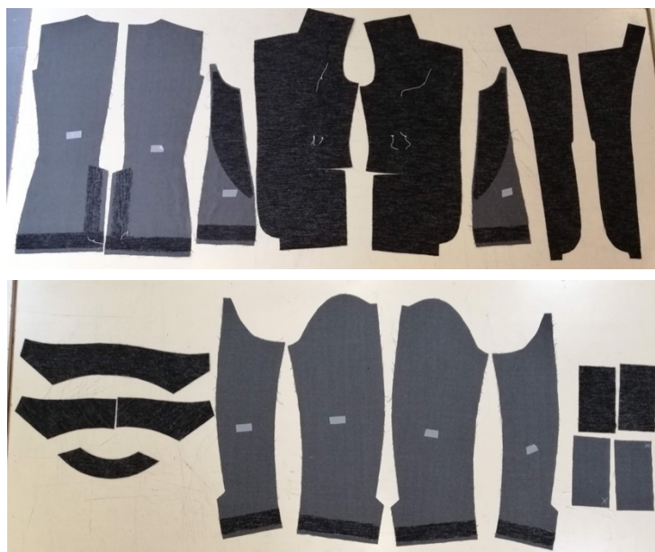
Figura 35 Locais onde se colocou entretela nos componentes do blazer (Fonte: autora, 2019).
