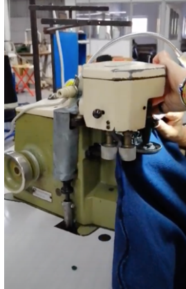
Figura 64 União das laterais do blazer na máquina Fully Fashion (Fonte: autora, Maio 2021).
