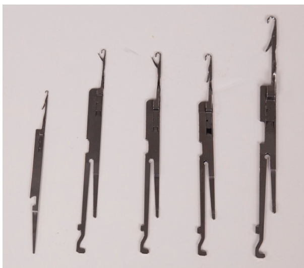
Figura 49 Alguns dos jogos de agulhas de lingueta dos teares da Fradimalhas Cinco jogos de agulhas dos teares da Fradimalhas, respetivamente da esquerda para a direita: jogo 12, jogo 6.2, jogo 5, jogo 4 e jogo 3.
