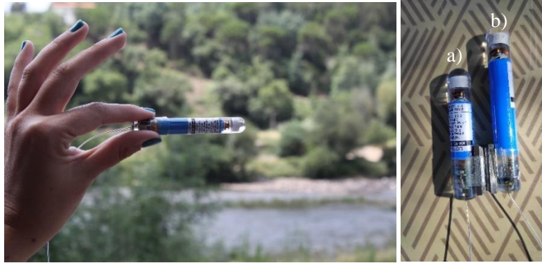
Figura 2.13. Transmissores Dual Mode utilizados no âmbito deste estudo: Modelo MM-RC-11-28 (a), e Modelo MM-RC-11-45 (b).
