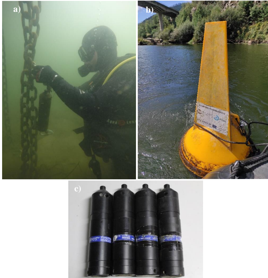
Figura 2.15. Mergulhador com escafandro autónomo a instalar um recetor acústico no rio Mondego (a), exemplo de boia de sinalização do local do recetor colocada no rio Mondego a montante do açude de Penacova (b), exemplos dos recetores acústicos utilizados (c).
