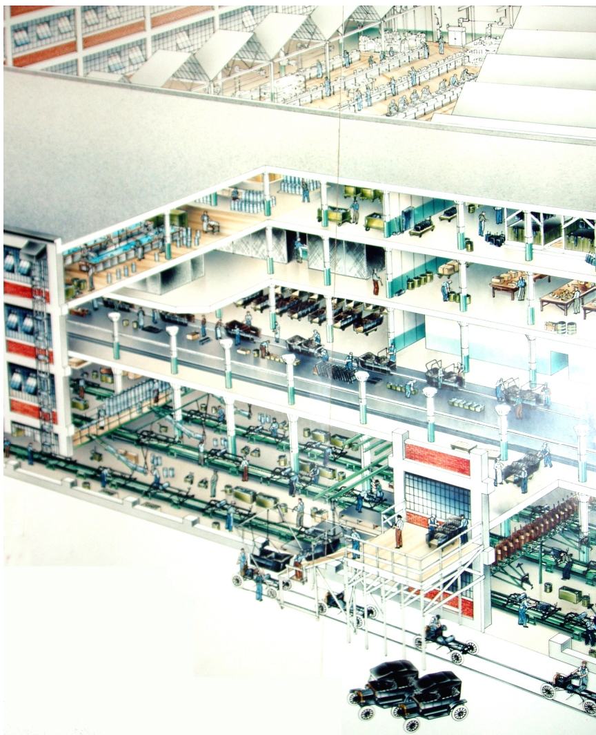
Fig. 5.65. Esquema da linha de montagem em Highland Park new shop (in MF).
