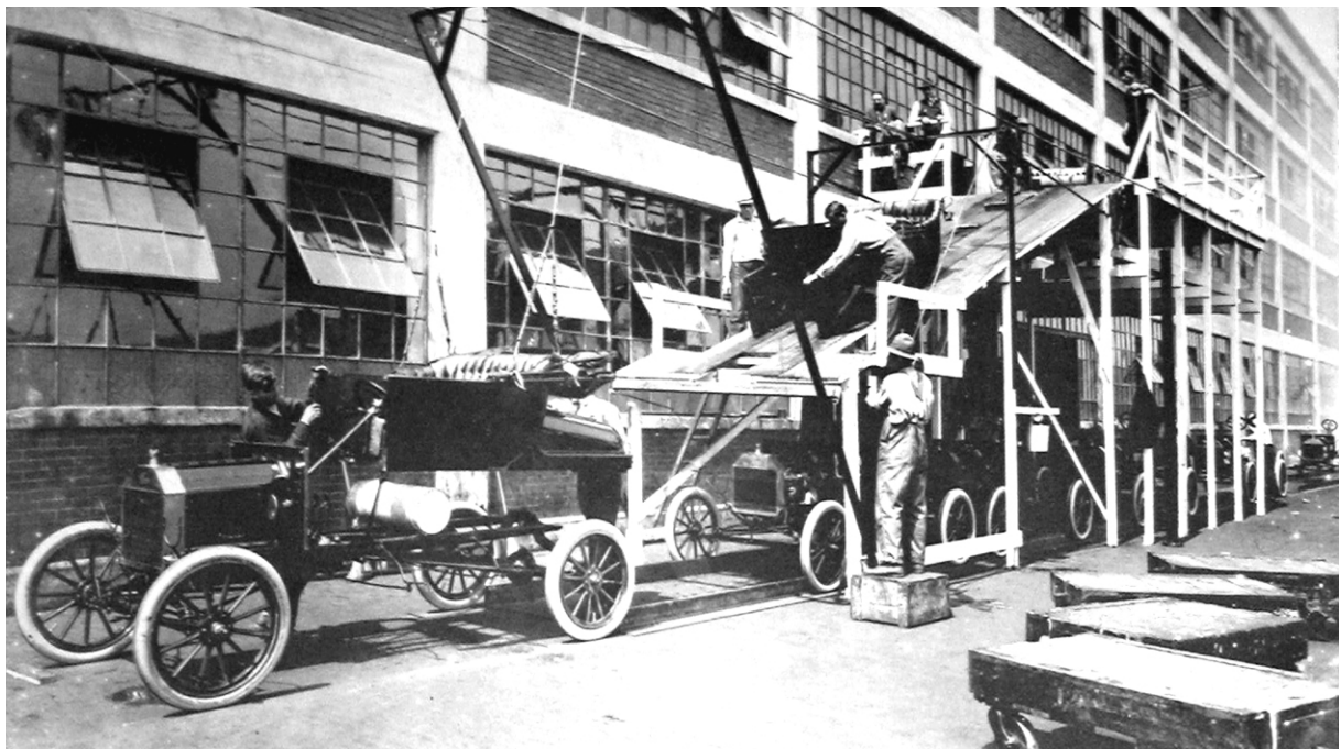
Fig. 5.52. Aspecto da montagem final dos automóveis no exterior da fábrica (in Ferry, 1987: 47).
