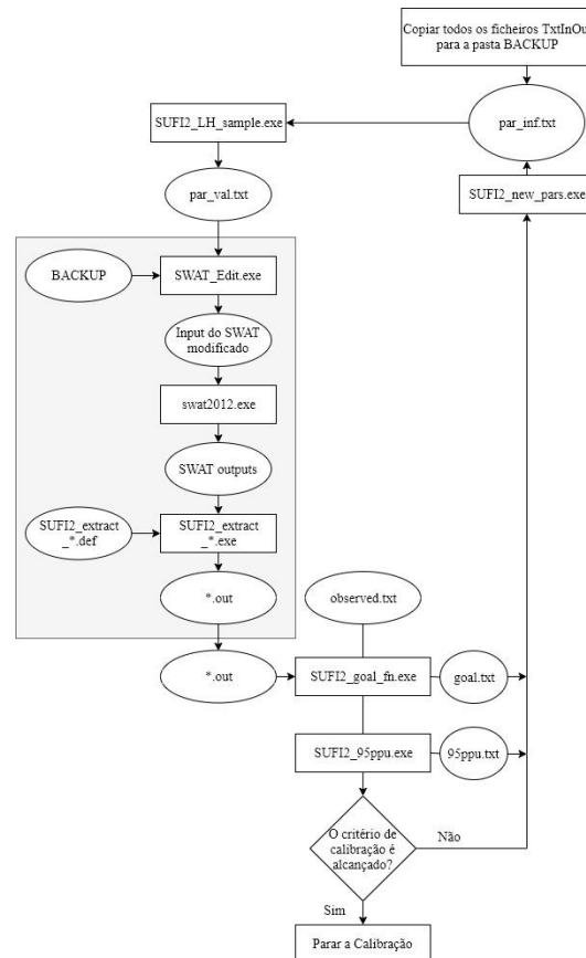
Figura A7.3 – Esquema de comandos do SWAT-CUP usando o método de calibração SUFI-2 (fonte adaptada de Rouholahnejad et al. 2012).
