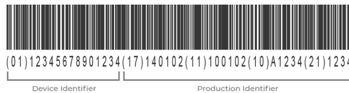
Figura 2 - Sistema UDI de um dispositivo médico, com os dois principais constituintes, UDI-ID e UDI-IP.
